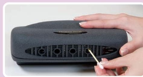
Pour nettoyer les pointes d'aiguilles, essuyez-les soit avec un cure-oreilles « Q-tip », préalablement trempé dans l'alcool à friction.
